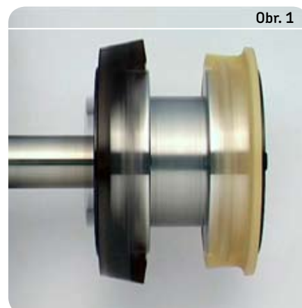
Polyamidová klec standardního ložiska SKF a ložiska E2 při otáčkách 8000 min -1 . Klec E2 vpravo vykazuje podstatně menší deformace.
